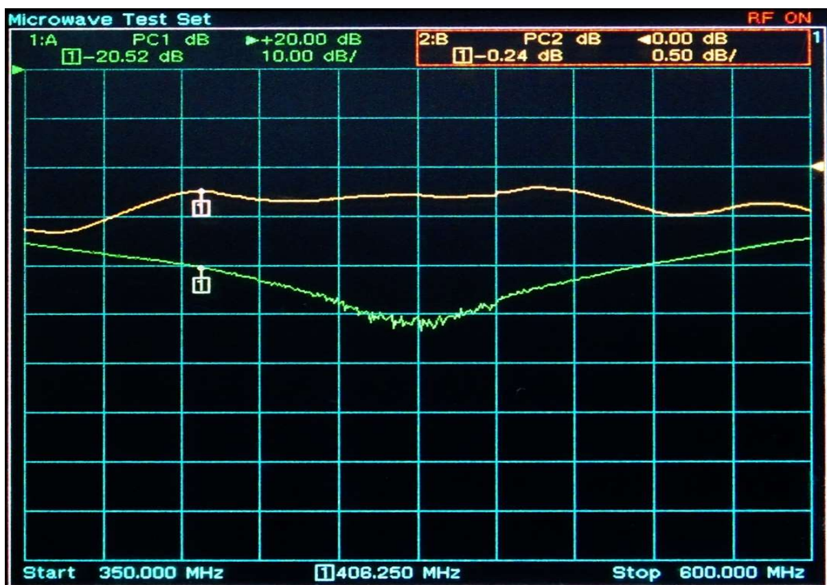
Obr. 3 Činitelů útlumu a přizpůsobení ochrany PKO-N-lambda-470M-BCD/F-F měřené v kmitočtovém pásmu 350 ÷ 600 MHz.
