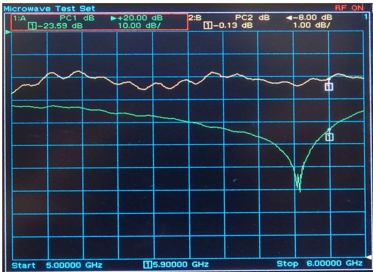
Obr. 3 Činitelé útlumu a přizpůsobení ochrany PKOpt-N-lambda-5,4/5,8G-BCD/F-M, měřené v kmitočtovém pásmu 5 až 6 GHz.
